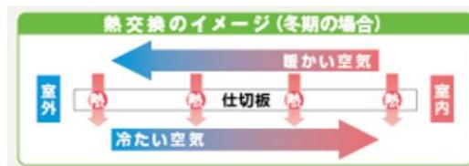
熱交換部は天井裏等に配置され、室内の吹き出し部は一般的な給排気口と同様の形状です。壁付けの操作用スイッチに単純換気(中段)と、熱交換換気(下段)の切替が付いていることで見分けられます。機能が知られていないため、単純な換気(排気)装置と混同されて、冷暖房中にも停止のままとなっている場合がよくあります。スイッチ横に、「使用すれば空調が良く効きます」等の、使用することによるメリットを説明する表示で有効活用ができます。24時間連続運用の場合は、無人の夜間時間帯の停止が考えられます。ビルなどの建設図書の機器一覧には熱交換機能の有無が記載されています。
